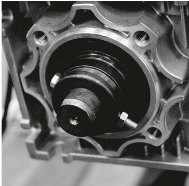
Krok 7. Prawidłowo założona śruba
