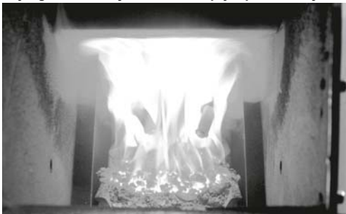
Prawidłowy ogień jest wtedy, kiedy obserwujemy, czysty, intensywnie żółty płomień.
