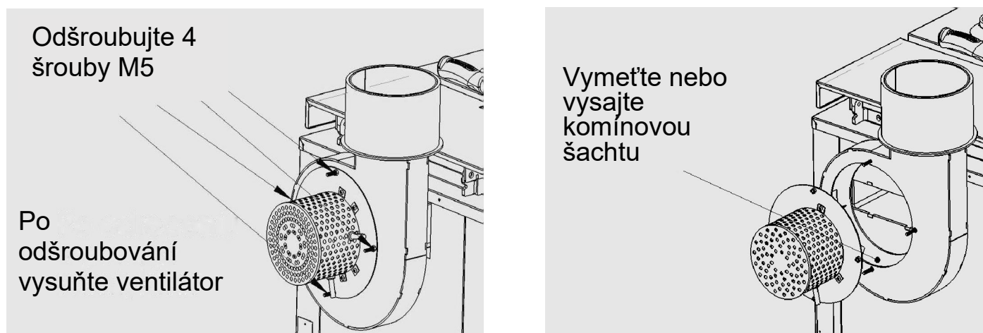
Obr. 11 Čištění komínové šachty
