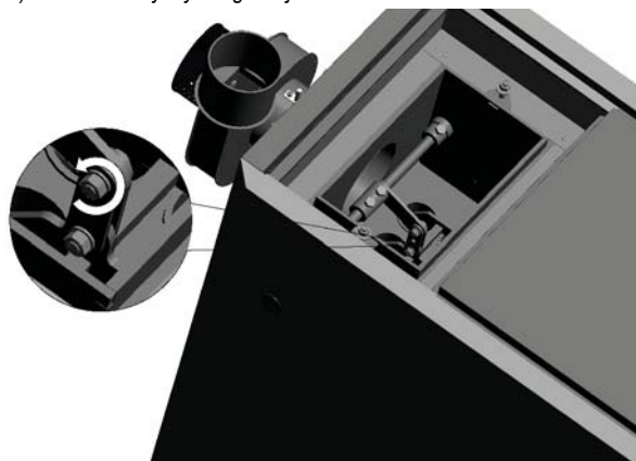
b) Demontaż ramienia mechanizmu czyszczącego
