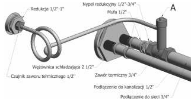
Rysunek 8. Sposób podłączenia termicznego zabezpieczenia odpływu.
