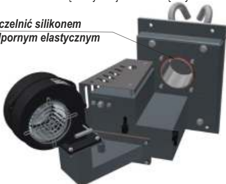
Fot.1. Miejsce uszczelnienia połączenia rury podawczej z palnikiem.
