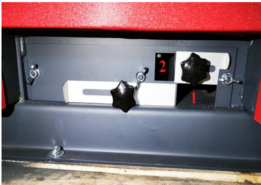
Abbildung 11: Einstellung der Sekundärluftmenge
