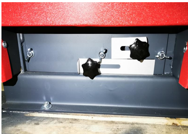
Abbildung 9: Lage der Klappen für die Sekundärluftzufuhr
