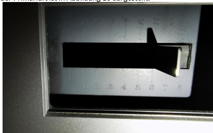
Abbildung 10: Einstellung der Primärluftmenge
