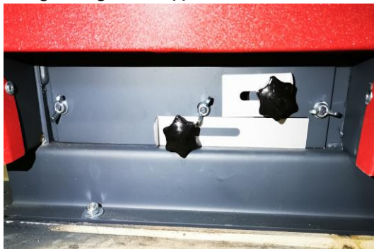
Abbildung 10: Lage der Klappen für die Sekundärluftzufuhr
