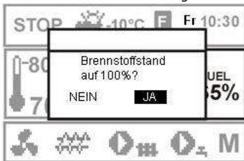
Abb. 23 Hilfsfenster mit Anzeige des Brennstoffstandes
