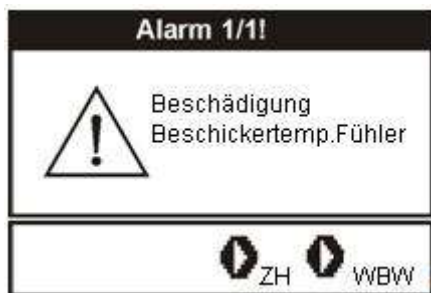
Abb. 52 Ansicht des Alarmkommunikats „Beschädigung des Beschicker-Temperaturfühlers“.
