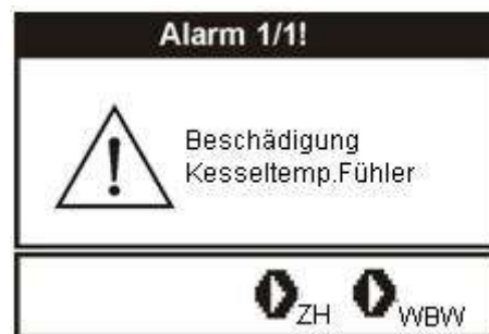
Abb. 51 Ansicht des Alarmkommunikats „Beschädigung des Kessel-Temperaturfühlers“.
