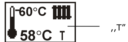
Abb. 38 Ansicht des Hauptdisplays nach Ansprechen des Thermostats
