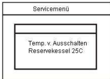
Abb. 40 Einschaltung der Steuerung des Reservekessels.
