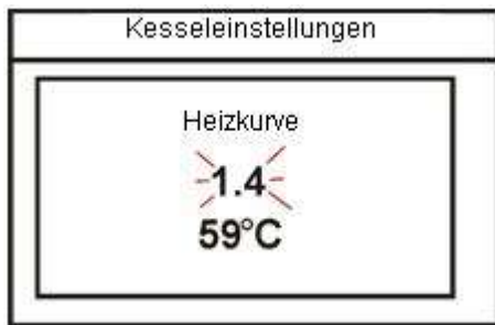
Abb. 44 Auswahl der Heizkurve des Kessels; wo: 1.4 – die ausgewählte Heizkurve, 59 – die aus der Heizkurve berechnete Temperatur für aktuell gemessene Außentemperatur beim Fühler CT4-P.
