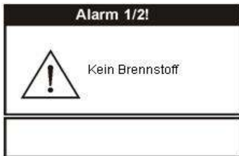
Abb. 46 Alarmkommunikat „Kein Brennstoff.“
