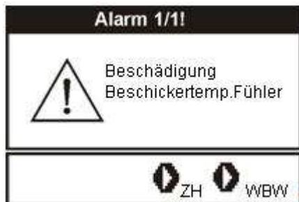
Abb. 49 Ansicht des Alarmkommunikats „Beschädigung des Beschicker-Temperaturfühlers“.
