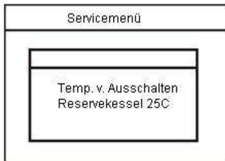
Abb. 37 Einschaltung der Steuerung des Reservekessels.
