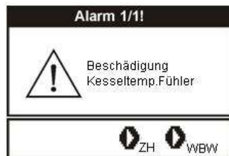
Abb. 48 Ansicht des Alarmkommunikats „Beschädigung des Kessel-Temperaturfühlers“.
