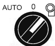
Bild 20. Position „Ventilator AN“ (Ventilator eingeschaltet)
