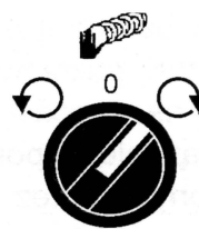
Bild 19. Erzwungenes Fördern in die Richtung des Brenner-Kopfes
